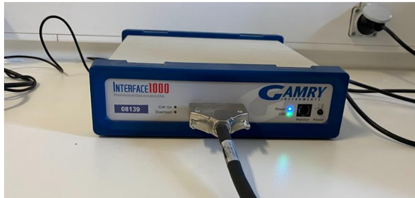
Görsel 5.1. Gamry Potentiostat Interface 1000 cihazı
