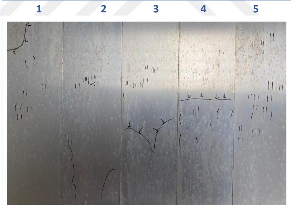
Görsel 6.5. Tuz sisi testi sonrası 2024-T3-Cr(III)-35 numunesi (çizgi, daha yüksek yoğunluklu çukur alanlarını temsil ederken, işaretli alanlar çukur sayımını temsil eder)
