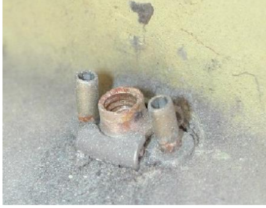
Görsel 3.5. ES-3B Viking uçağının yatay kuyruk bölgesinde galvanik korozyon ( http-3 )
