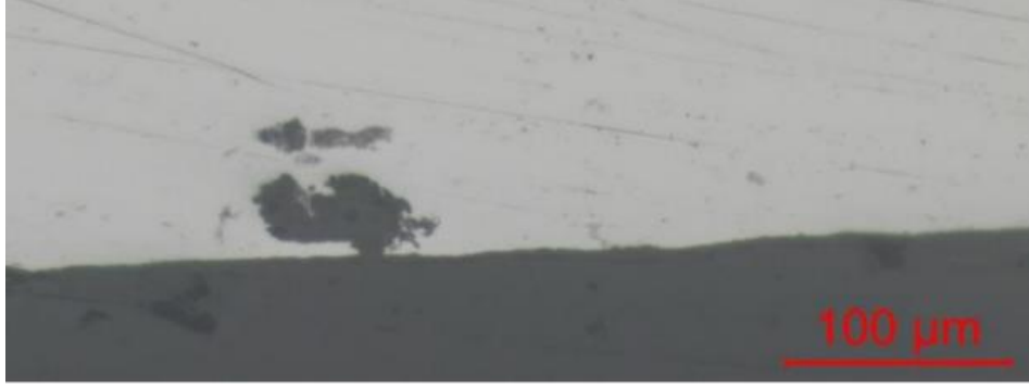
Görsel 3.1. AA 2050 T8 alüminyum alaşımının çukurcuk korozyonu görüntüsü (Peltier & Thierry, 2022)
