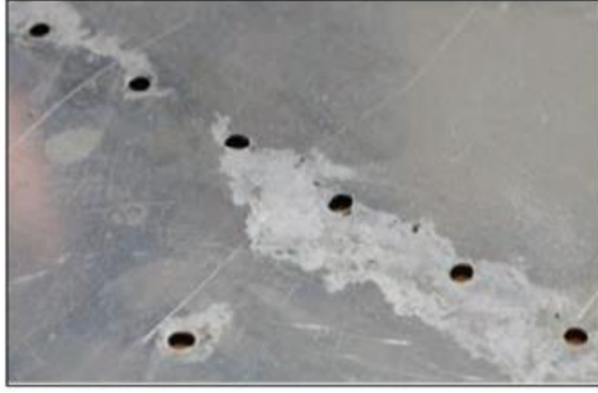
Görsel 3.3. Alüminyum havacılık malzemesinde homojen dağılımlı korozyon (Li vd., 2021)
