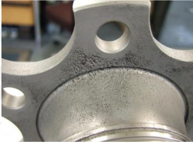
Görsel 3.2. Eski model uçak motoru krank milinde görülen çukurcuk korozyonu ( http-2 )
