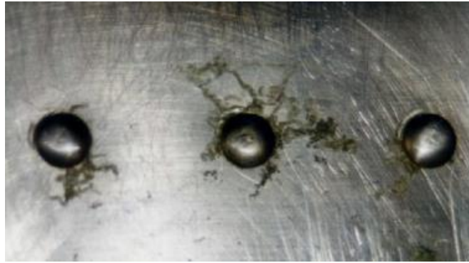
Görsel 3.6. Filiform korozyon ( http-2 )
