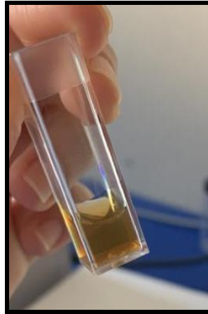
Şekil 3-1: Zetasizerda (HORIBA nanoPartica SZ-100V2 nanopartikül analiz cihazı, Japonya) nanogümüş partiküllerinin boyutunun ölçme işlemi.
