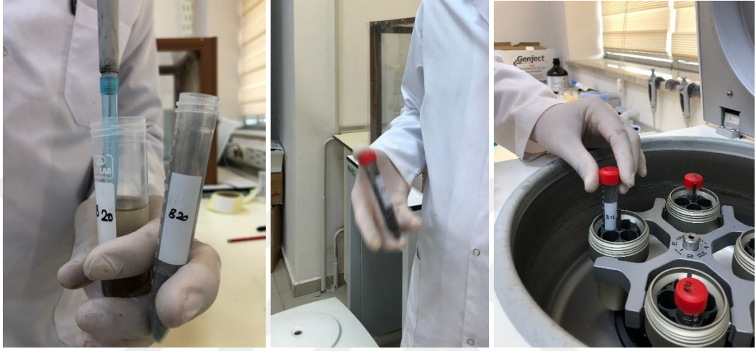
Şekil 7. Üst fazdan 15 ml'lik tüpe aktarma, çalkalama ve santrifüj işlemi
