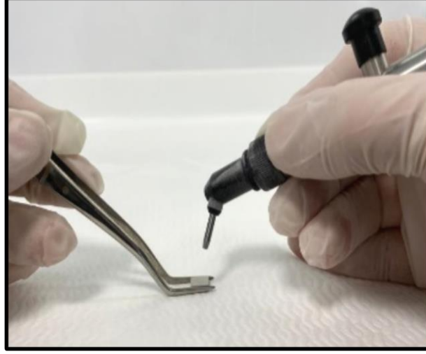
Şekil 3.10. Tribokimyasal kumlama işleminin uygulanması
