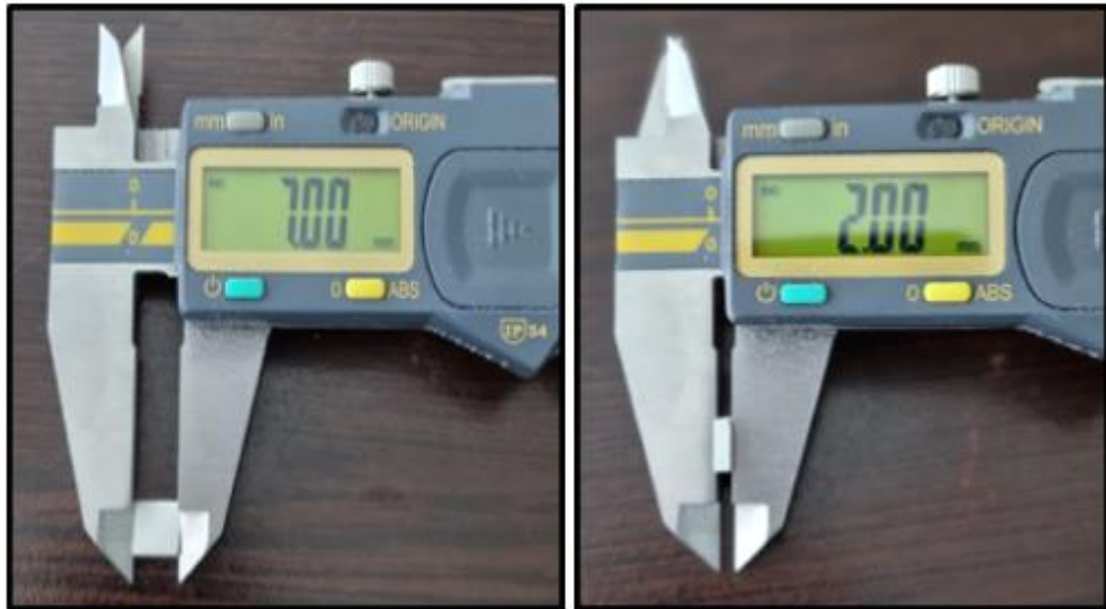
Şekil 3.3. Örnek boyutlarının dijital kumpas ile ölçülmesi
