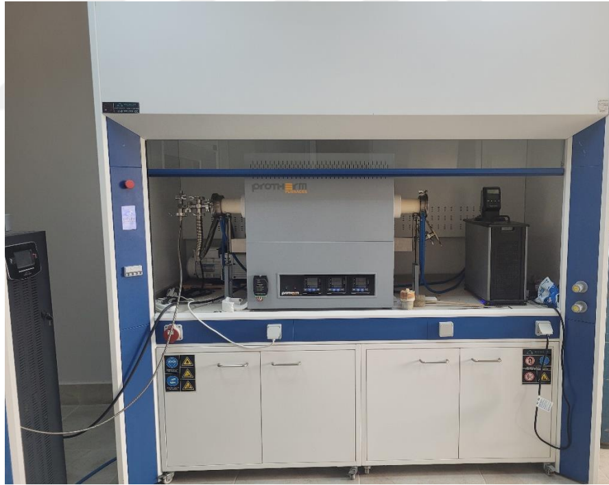
Şekil 3.9. Sinterleme işleminin yapıldığı silindir fırın (PROTHERM FURNACE-PTF 17/75/450-3Z)
