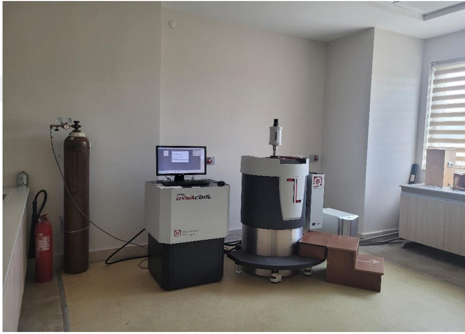
Şekil 3.14. PPMS (Physical Property Measurement System) deney düzeneği (Quantum Design- Dynacool-9)
