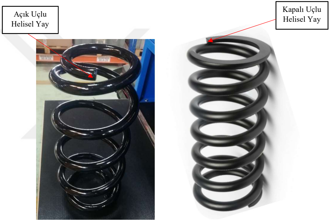
Şekil 4.2. Açık ve kapalı uçlu helisel yay
