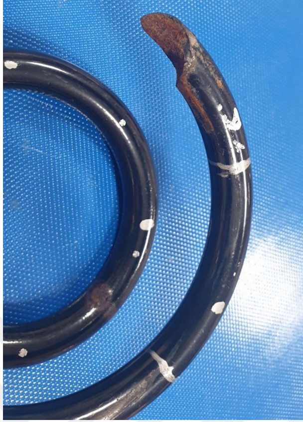
Şekil 4.14. Helisel yay yüzeyinde görülen korozyon
