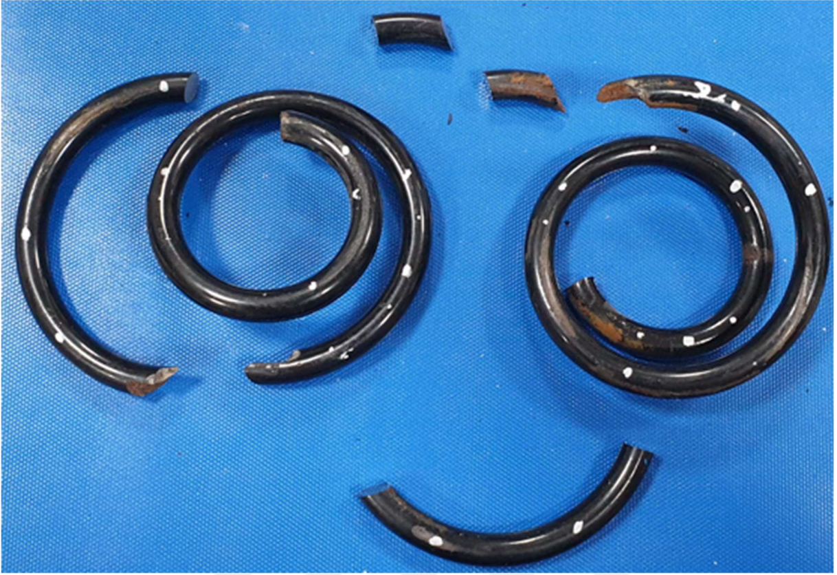
Şekil 4.16. Korozyon oluşumu sonucu deformasyon görüntüleri
