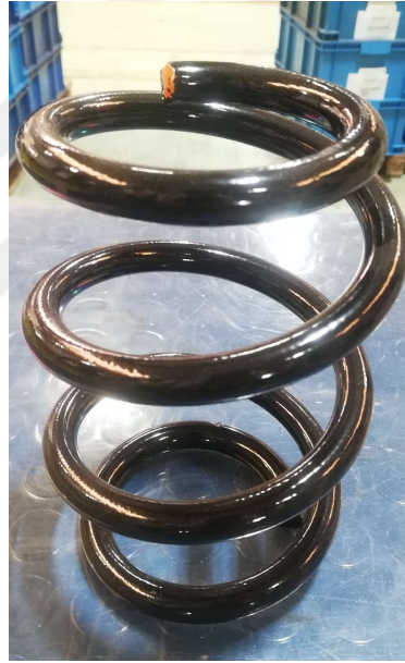
Şekil 4.11. Helisel yayın korozyon cihazına yerleştirilmeden görünümü
