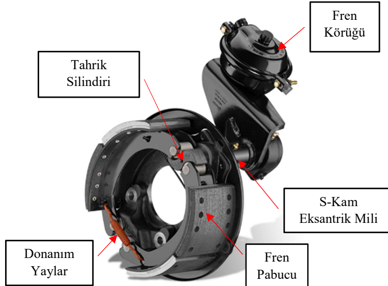
Şekil 3.12. S-Kamlı simpleks kampanalı fren konstrüksiyonu
