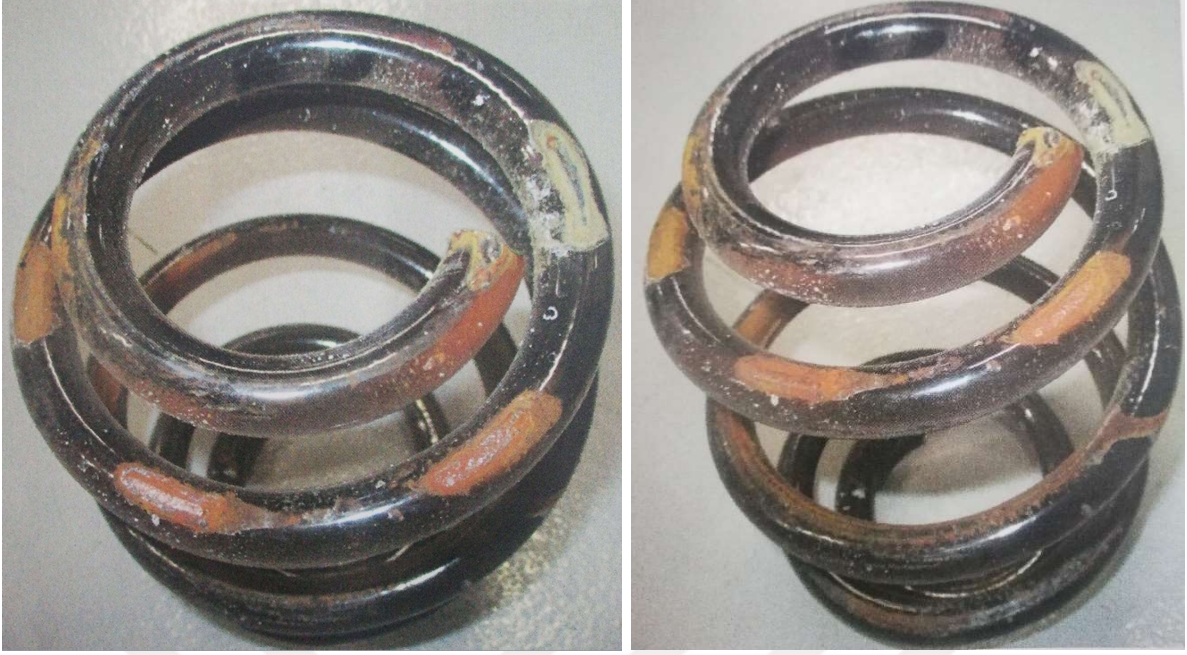
Şekil 4.12. Helisel yay yüzeyinde korozyon başlangıç görünümü
