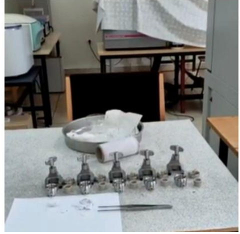
Şekil 18. a) Li-iyon pil hazırlanma aşamasındaki havasız ortam kabini (glowbox), b) Li-iyon pil hücreleri
