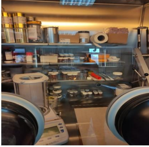
Şekil 18. a) Li-iyon pil hazırlanma aşamasındaki havasız ortam kabini (glowbox), b) Li-iyon pil hücreleri
