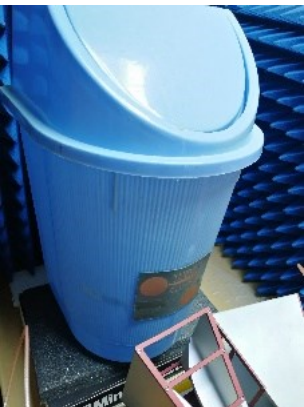
Şekil 3.48. Düz pozisyon için (a) ve bükülmüş pozisyon için (b) plastik yüzey üzerine yerleştirilmiş etiketin farklı pozisyonlardaki ölçüm düzeneği ve elde edilen ölçüm sonuçlarının simülasyon sonuçları ile karşılaştırılması
