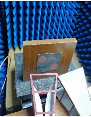
Şekil 3.49. Bükülmüş pozisyonda plastik su şişesi için (a) ve düz pozisyonda tahta malzeme için (b) kurulan ölçüm düzeneği ve elde edilen ölçüm sonuçları ile simülasyon sonuçlarının karşılaştırılması
