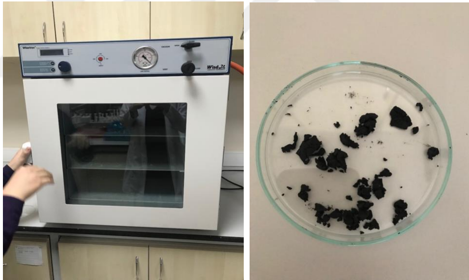
Şekil 3.5 : Vakumlu fırında 24 saat kurumaya bırakılan örnekler.
