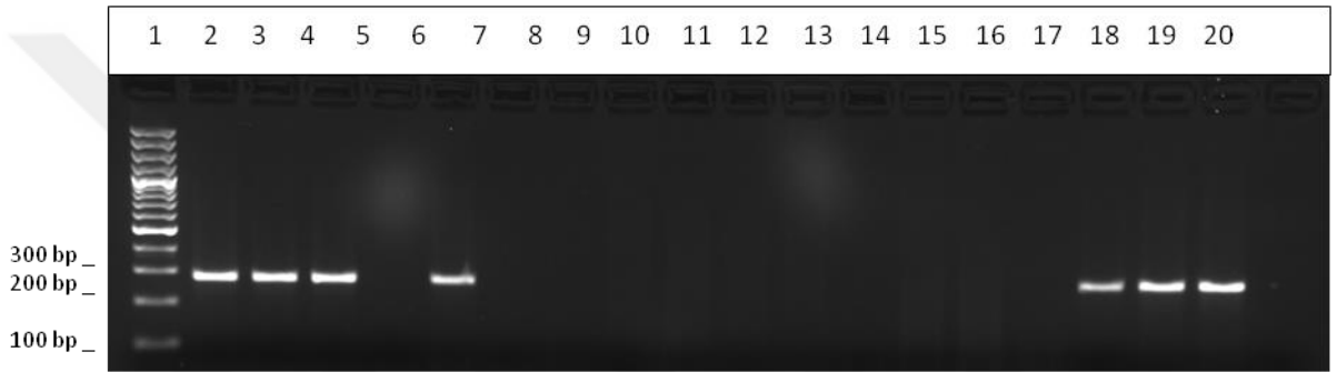
Şekil 4.3 : Zein primeri için PCR örneklerinin agaroz jel görüntüsü. 1) 100 bp DNA Ladder (Thermo Scientific) 2) GM Mısır (pozitif kontrol); 3-8) bisküvi; 9-12) kek; 13-15) kraker; 16-17) Mısır cipsleri; 18-19) Mısır unu; 20) Buğday DNA'sı (negatif kontrol).
