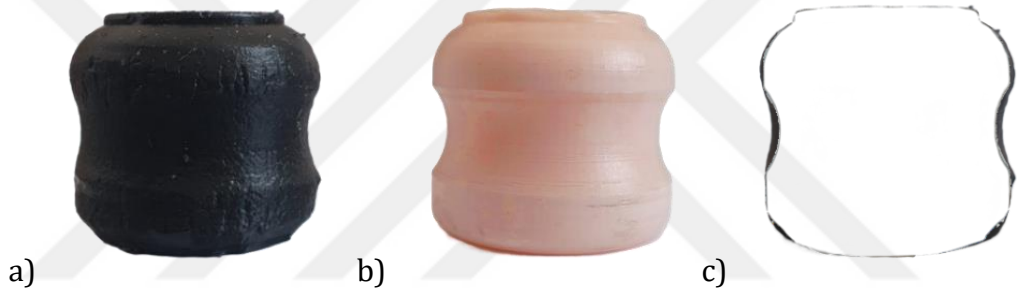
Şekil 4.21. a) Fotoğraf Eldesi ile Üretilen Ürün b) Çizim ile Üretilen Ürün c) Fark Görseli
