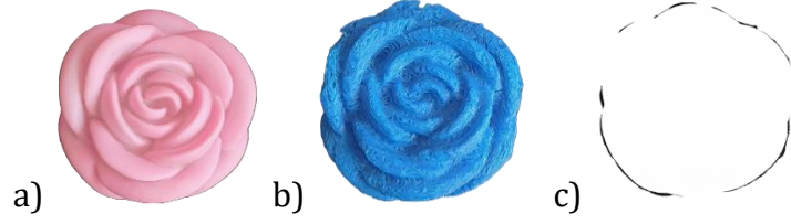
Şekil 4.39. a) Orijinal Nesne b) Fotoğraf Eldesi ile Üretilen Ürün c) Fark Görseli
