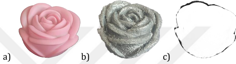
Şekil 4.42. a) Fotoğraf Eldesi ile Üretilen Ürün b) Çizim ile Üretilen Ürün c) Fark Görseli
