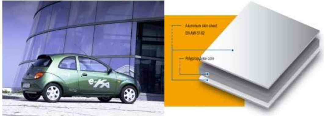
Şekil 2. 2. : Hylite isimli alüminyum sandviç panelin Ford E-Ka’da kullanımı
