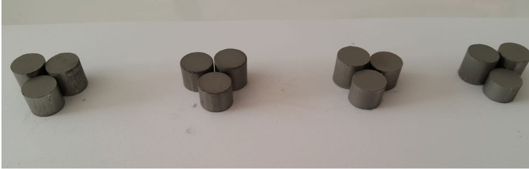
Şekil 2.3. Metalografik işlemlerle preslenerek hazır hale getirilen numuneler
