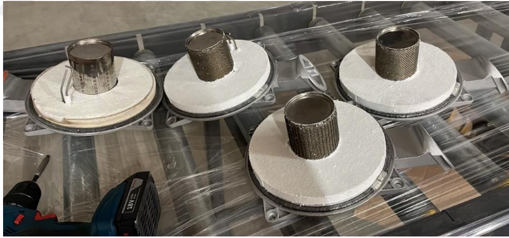
Görsel 4.20. Yanma odası kapağına montajlanmış brülörler
