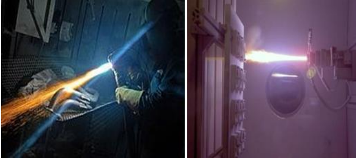
Şekil 2.9. Plazma sprej kaplama uygulamaları [16]
