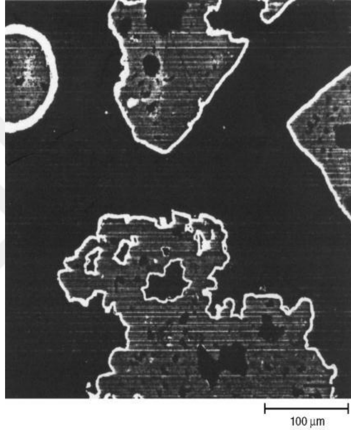
Şekil 2.2. Gözenekli yüzey üzerine yapılmış CVD işlemi [6]
