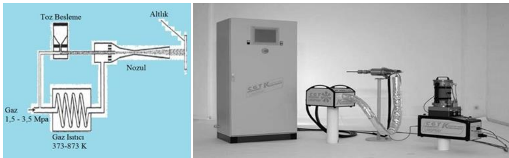
Şekil 2.14. Soğuk gaz sprej şeması [18]
