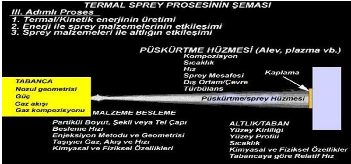
Şekil 2.8. Termal Sprej Yöntemi Prosesine etki eden faktörler [13]
