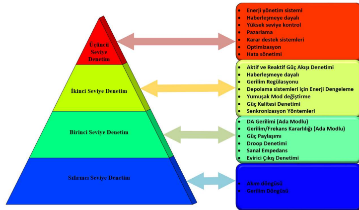
Şekil 2.11: Mikro şebekelerde hiyerarşik denetim sistemleri.
