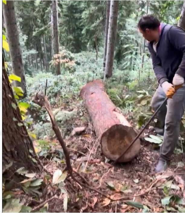
Şekil 3. Manivela ile Tomrukların Kaydırılması (Foto: M. Acar 07.09.2022)
