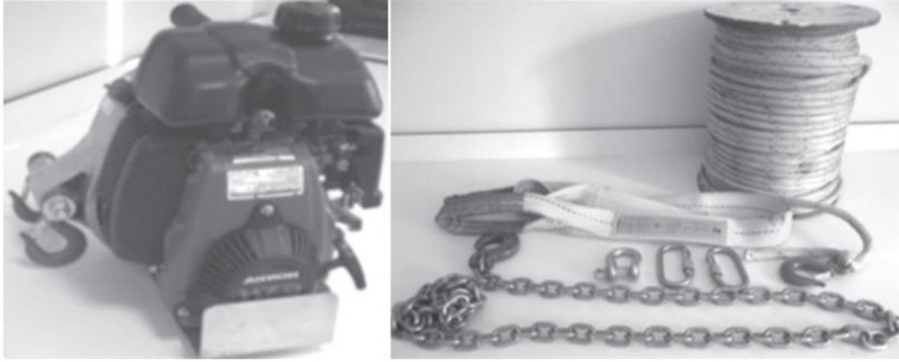
Şekil 10. Taşınabilir El Vinci, Sabitleme ve Yönlendirme Halatları ve Çekme Halatı (Akay vd., 2023)
