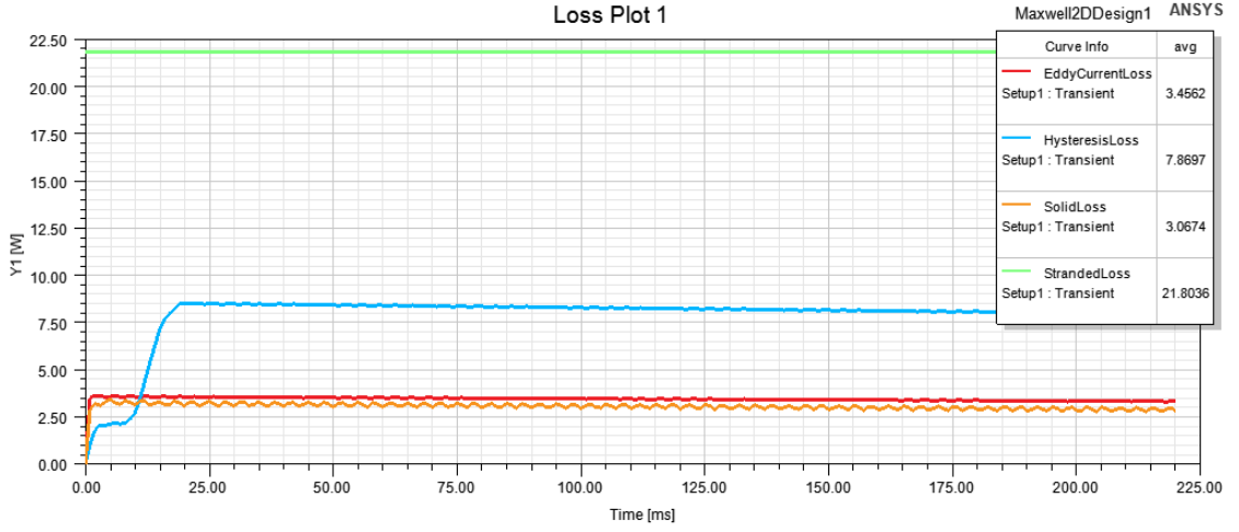
Şekil 4.18 22 Kutup için Nominal Akımda Oluşan Kayıplar
