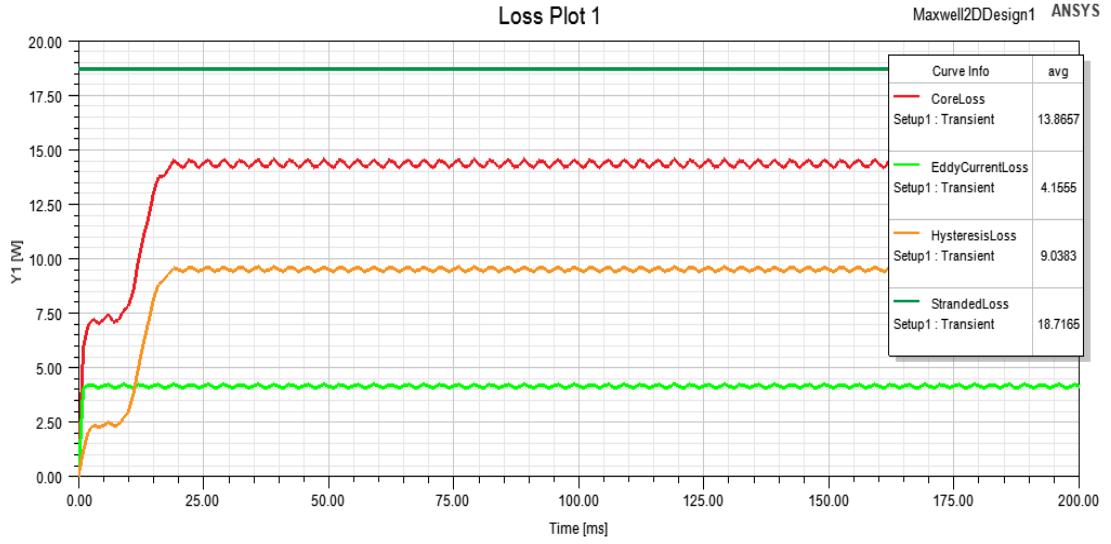
Şekil 4.3 20 Kutup için Nominal Akımda Oluşan Kayıplar
