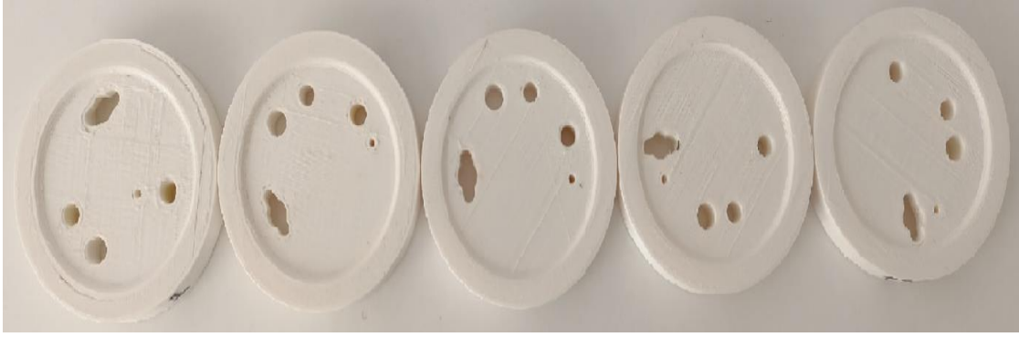
Şekil 2.2 Elektrot pozisyonlarını içeren kapak modelleri
