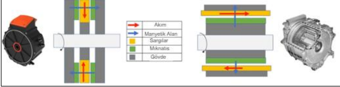
Şekil 3.2. Eksenel akılı motor ve radyal akılı motor, akım ve akı yolları [103]
