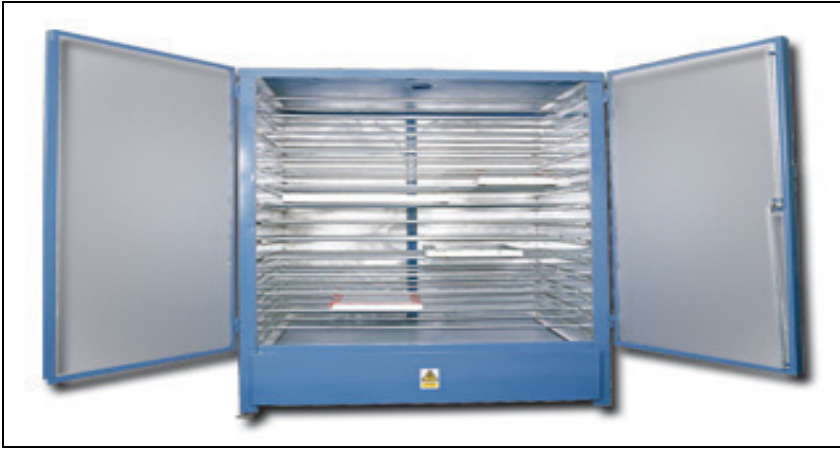
Resim 3.3.2. Pelet Makinesinden Çıkan Yemlerin Kurutulduğu Kurutma Dolabı.
