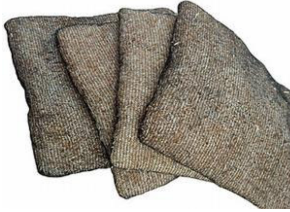
Şekil 2.9. Samandan yapılmış ped malzemesi
