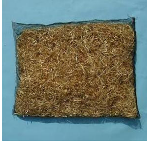
Şekil 2.8. Kavak talaşından yapılmış ped malzemesi
