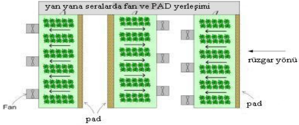
Şekil 2.14. Yan yana seralarda fan ve pad yerleşimi (Bucklin, 1993)
