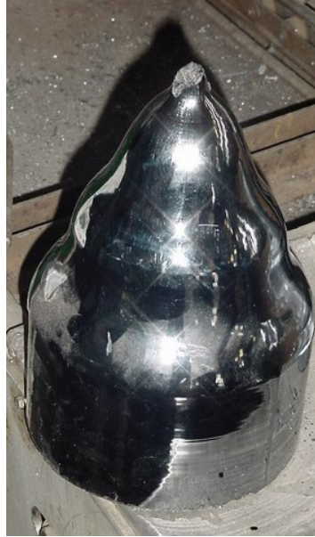
Şekil 3.2. Czochralski yöntemi ile hazırlanmış silikon külçesi
