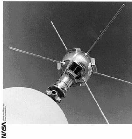
Şekil 1.4. Güneř gözelerinin kullanıldığı Vanguard 1 uydusu
