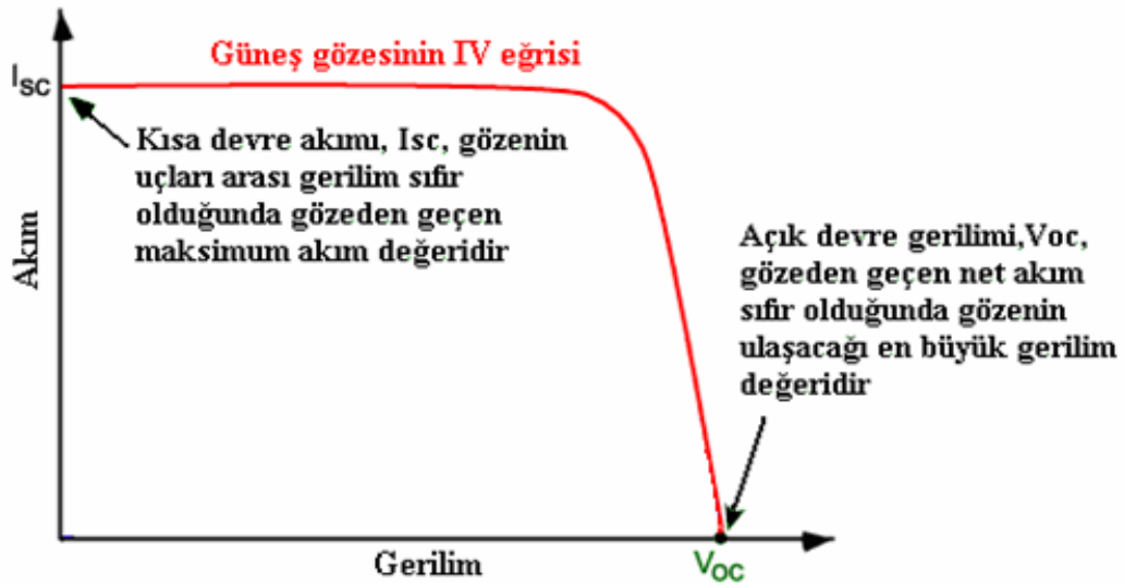
Şekil 2.8. I-V eğrisinde açık devre geriliminin ve kısa devre akımının gösterimi
