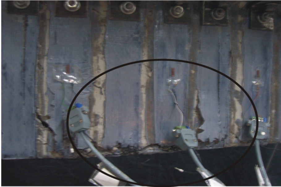
Şekil 3.69 CFRP şeritlerde kopma
