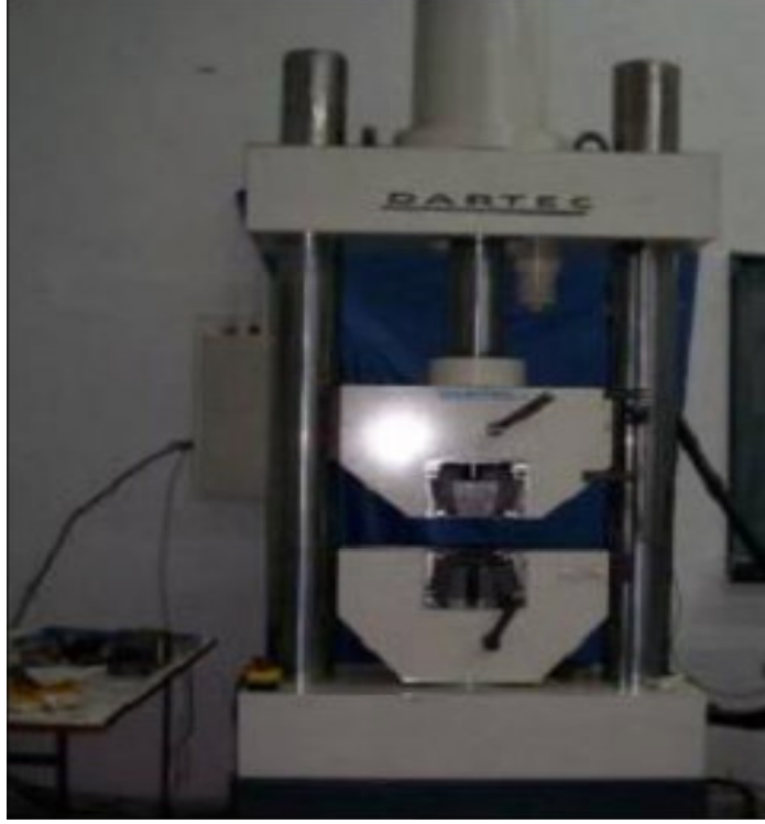
Şekil 2.12 Donatı çekme deneylerinde kullanılan deney düzeneği
