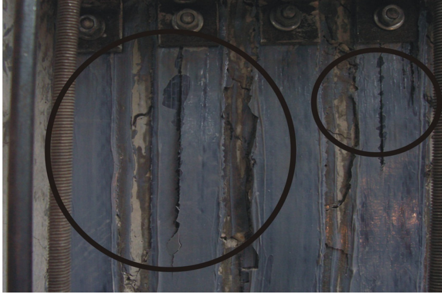
Şekil 3.67 Lifler doğrultusunda yırtılma, 2 ve 4 no'lu CFRP şeritler
