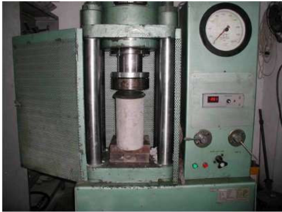
Şekil 2.13 Beton silindir deneyi
