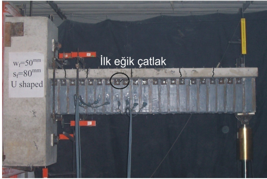
Şekil 3.50 İlk eğik çatlak, Deney Elemanı-8
