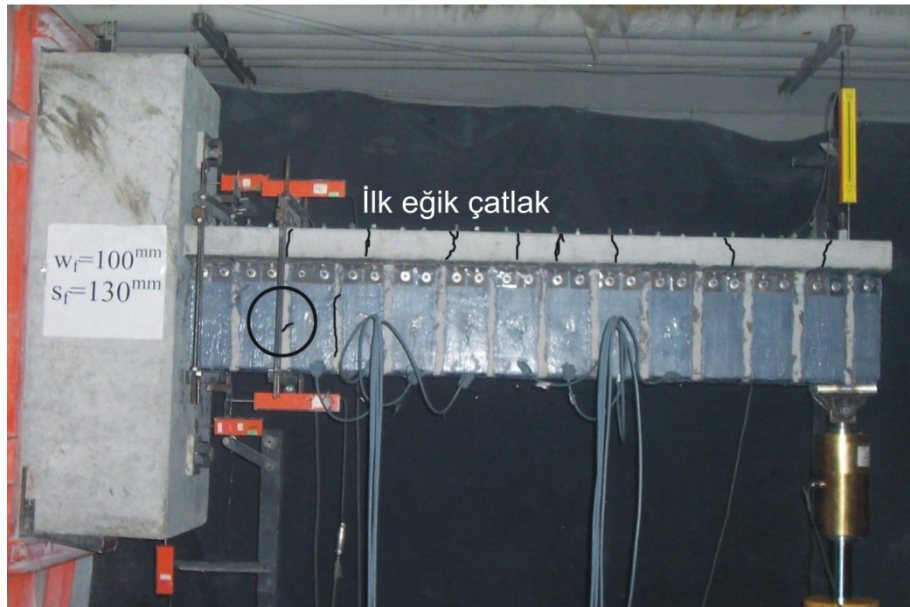
Şekil 3.76 İlk eğik çatlak, Deney Elemanı-11
