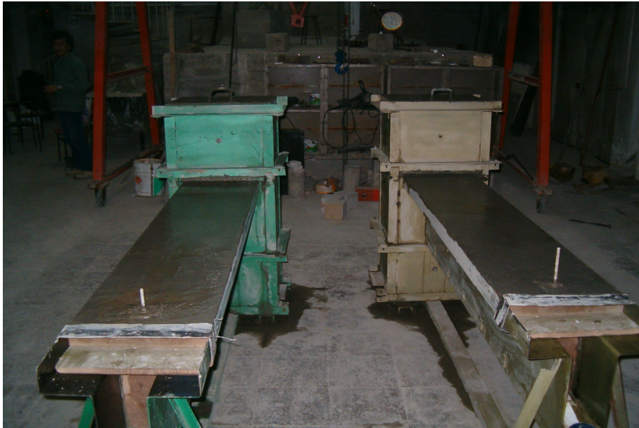
Şekil 2.16 Beton dökümü tamamlanmış deney elemanları
