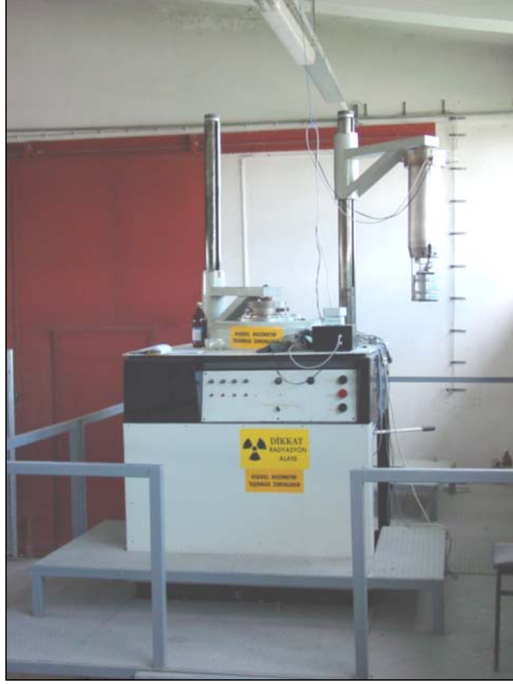
Şekil 4.1. Bakla tohumlarının ışımlandığı gama cell kaynağı cihazı (ANTHAM, TAEK)
