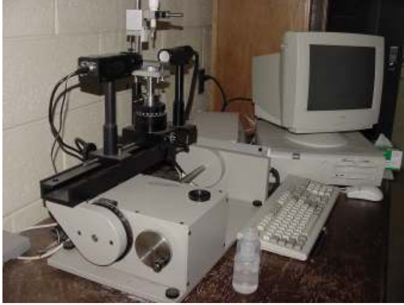
Şekil 3.2. Temas açısı ölçüm cihazı
