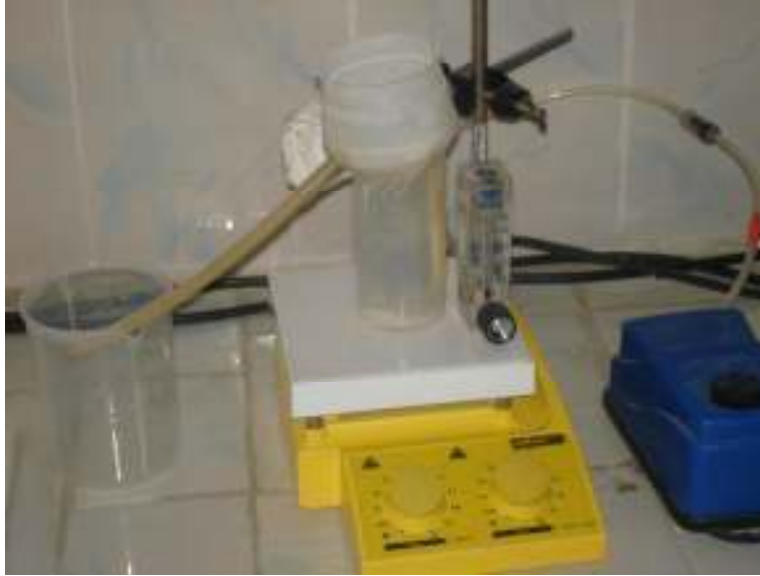
Şekil 3.5. Mikroflotasyon deney düzeneği
