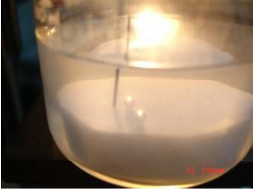
Şekil 3.3. Mineralin parlak kesitine hava kabarcığının tutunması
