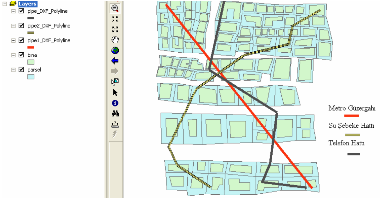
Şekil 6.3.j İki boyutlu düzlemde Metro Hattı, Su Şebeke Hattı, Telefon Hattı, Parseller ve Binaların ArcMap yazılımında gösterilmesi
