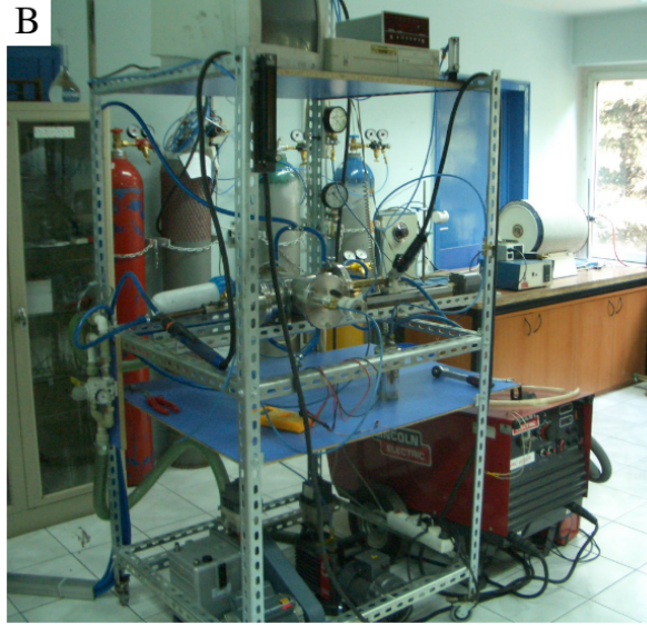
Şekil 1 Deneylerde ilk olarak kullanılan ark boşalım reaktörü. (A) şematik yapısı, (B) görüntüsü.
