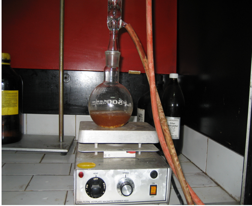
Resim 6.1. Geri soğutucu altında gerçekleştirilen tepkime [39]
