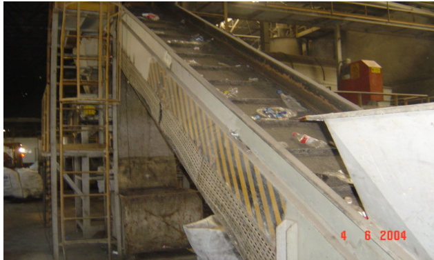
Resim 3.17. Balyası açılan PET ambalaj atıklarının konveyör bant ile sevki [41]
