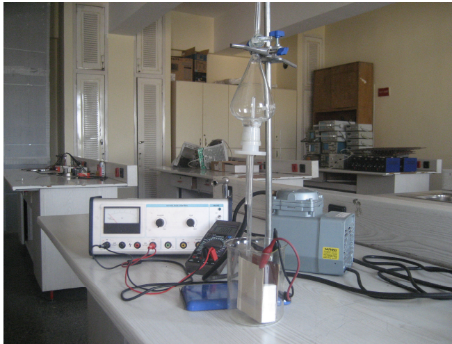
Resim 5.4. Elektrostatik ayırım düzeneği [39]
