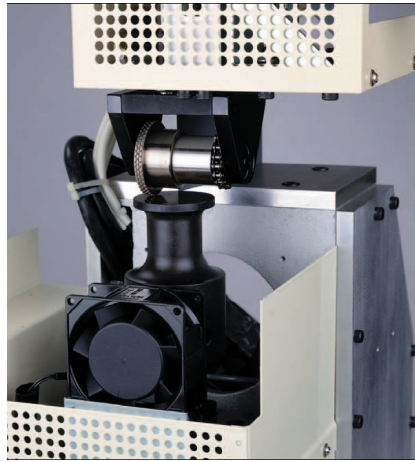
Őekil 4.8. Yatay Konumlandırılmış ve Dairesel Hareket Eden Horn (Altta) (Sonobond Ultrasonik Kaynak Makinesi Katalogları, 2007)
