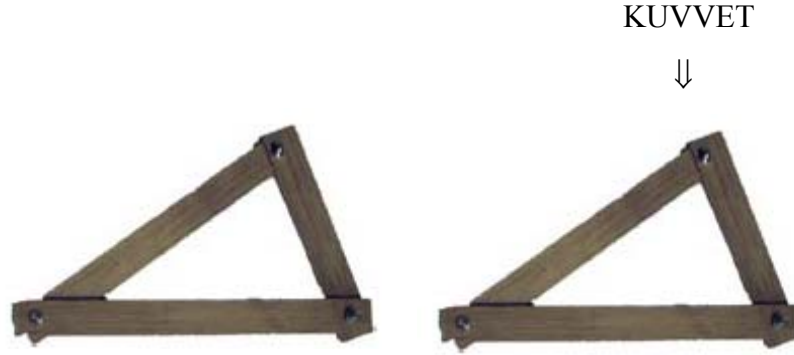
Şekil 2.3. Bir Üçgenin; Ağırlık Uygulanmamış ve Uygulanmış Hali
