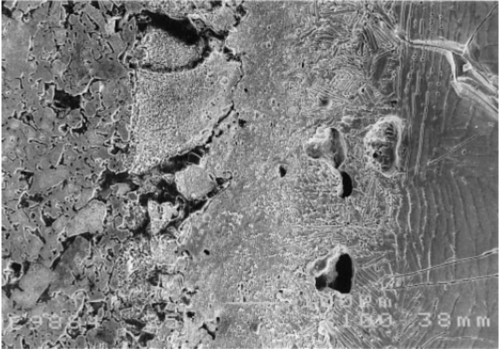
Şekil 2.2; 1750^{\circ}\text{C}/7 dk reaksiyon neticesinde zirkonyum ve titanyum arayüzeyinin SEM mikrografı. Bölge A:reaksiyona girmemiş \text{ZrO}_2 , Bölge B: \text{ZrO}_{2-x} , Bölge C:kimyasal reaksiyon tabakası, Bölge D: \alpha -tabakası, Bölge E:reaksiyona girmemiş titanyum (Lin ve Lin, 1998).
