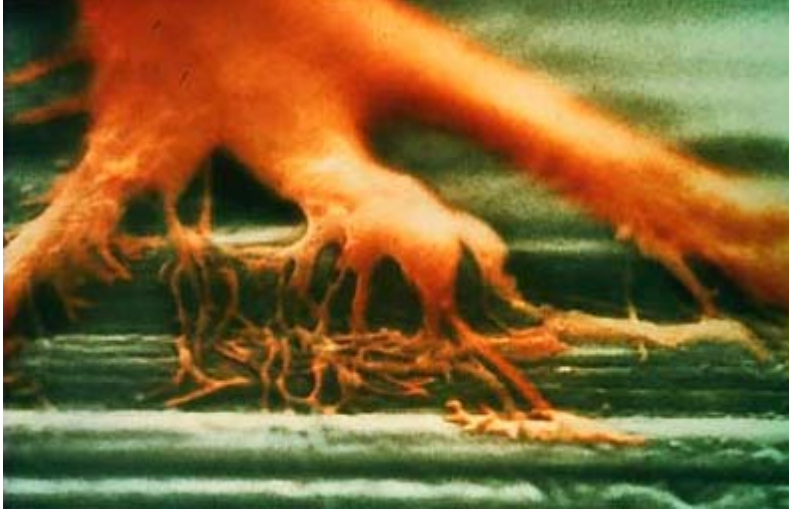
Şekil 2.3; Titanyuma tutunan kemik hücresinin taramalı elektron mikroskobu (SEM) görüntüsü ( http://www.branemark.se/ )
