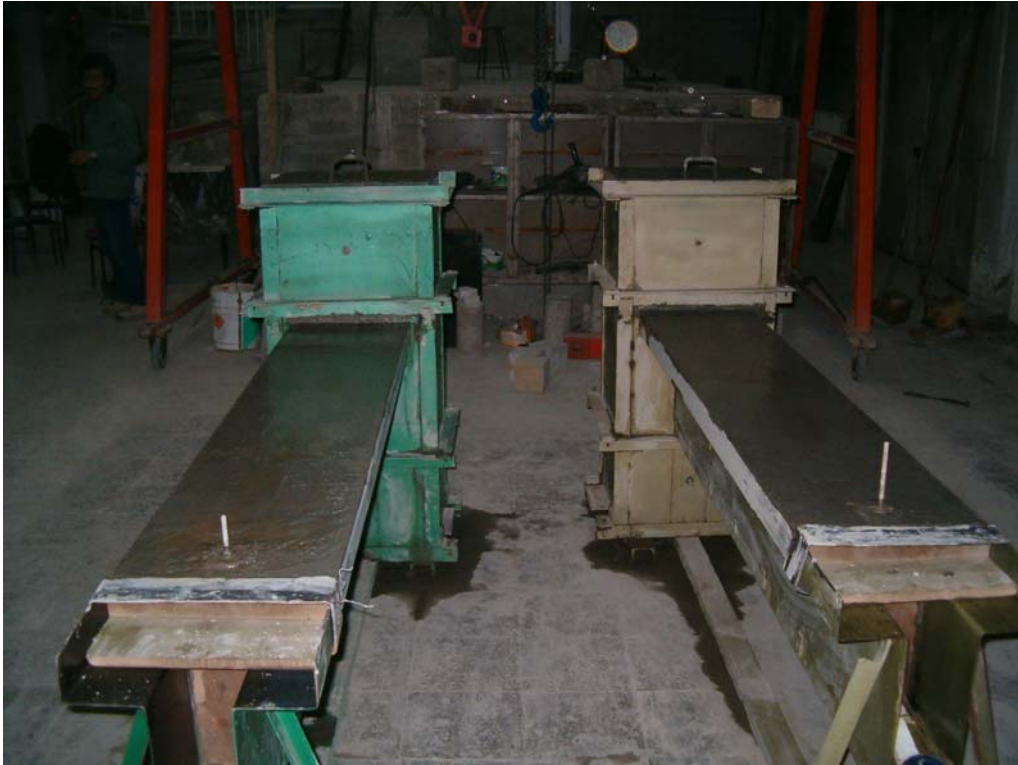
Resim 2.9. Beton dökümü tamamlanmış deney elemanları [21]
