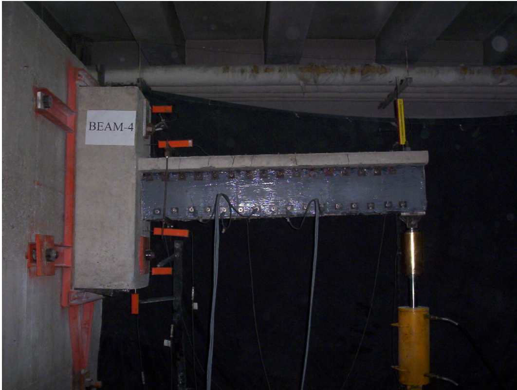
Resim 3.8. İleri yüklemeye maksimum kiriş uç deplasmanı (51,2 mm) [21]
