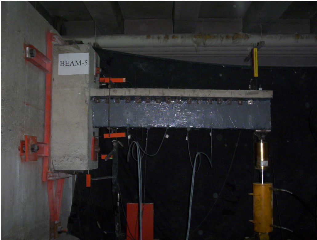
Resim 3.11. Geri yüklemde maksimum kiriş uç deplasmanı (50,4 mm) [21]
