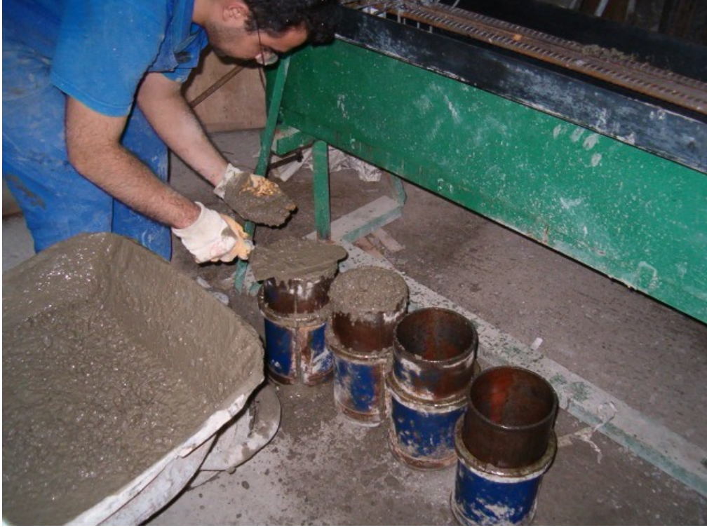
Resim 2.8. Silindir numune alınması [21]
