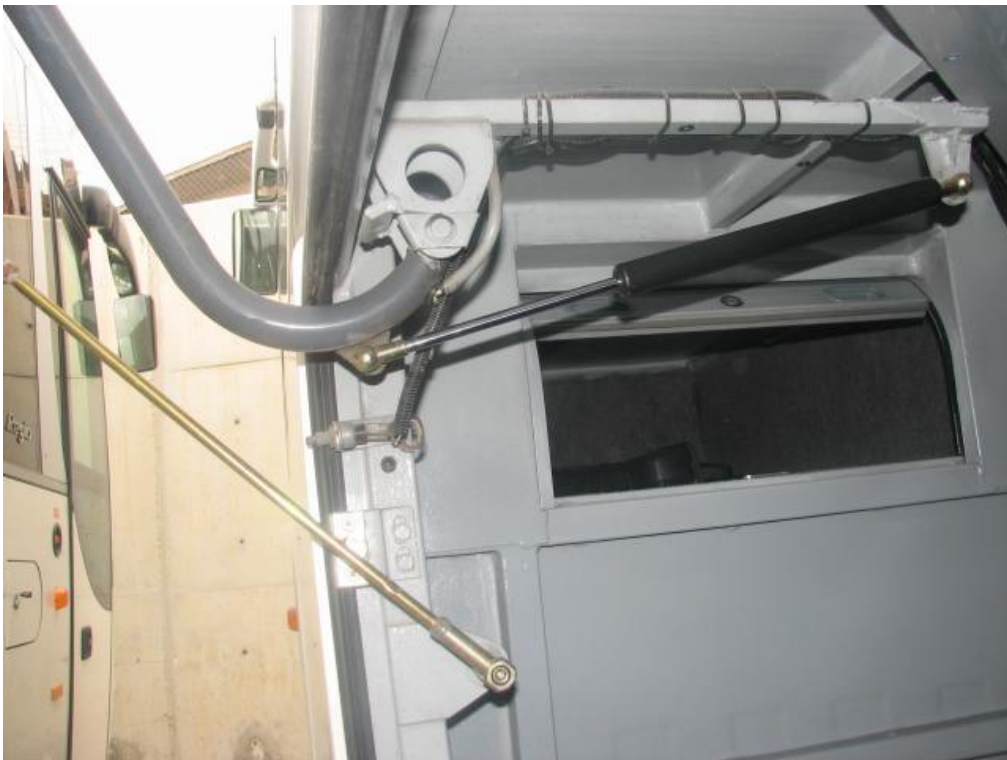
Resim1.3. Neoplan Tourliner bagaj mekanizması açık pozisyonu
