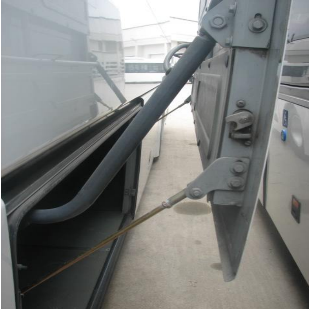
Resim 1.4. Neoplan Tourliner bagaj mekanizması yan görünüşü
