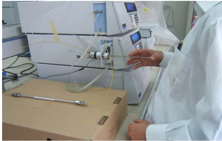
Resim 3.2. Fenolik standartların ve madımak örneklerinin HPLC cihazına enjeksiyonu
