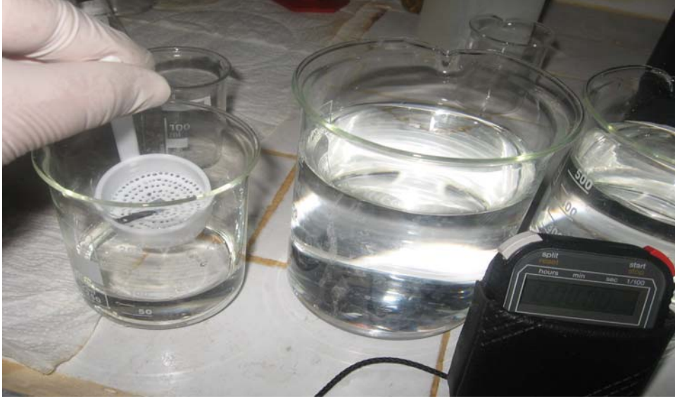
Resim 1.13. Numunenin aşındırma solüsyonuna daldırılışı
