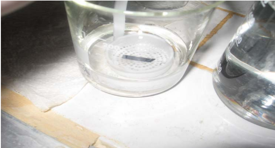
Resim 1.14. Numunenin aşındırma solüsyonunda aşındırılması
