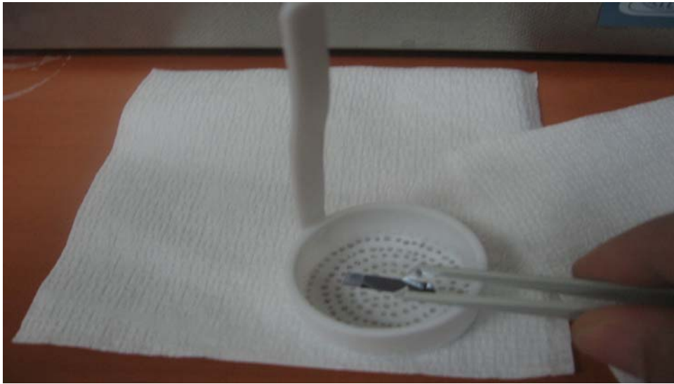
Resim 1.12. Numunenin teflon süzgece yerleştirilmesi
