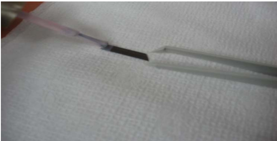
Resim 1.10. Ön yüzde aşındırılmayacak kısmın maskelenişi
