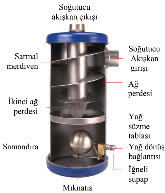
EK 1.5. Yağ ayırıcısının resmi ve teknik özellikleri
