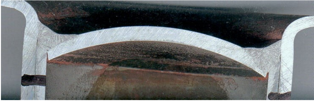
Şekil 6.6: Ön amortisör rezerve grubu MAG kaynağı sonrası nufuziyet görünümü
