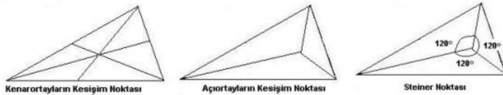
Şekil 3.4 Hata Üçgeninde Geometri Bilgisi Kullanarak Konum Belirleme
