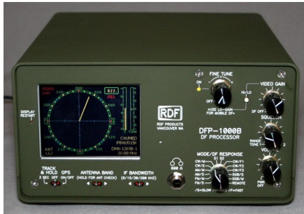
Şekil 2.2 RYBS Kerteriz İşlemci ve Ekran Örneği
