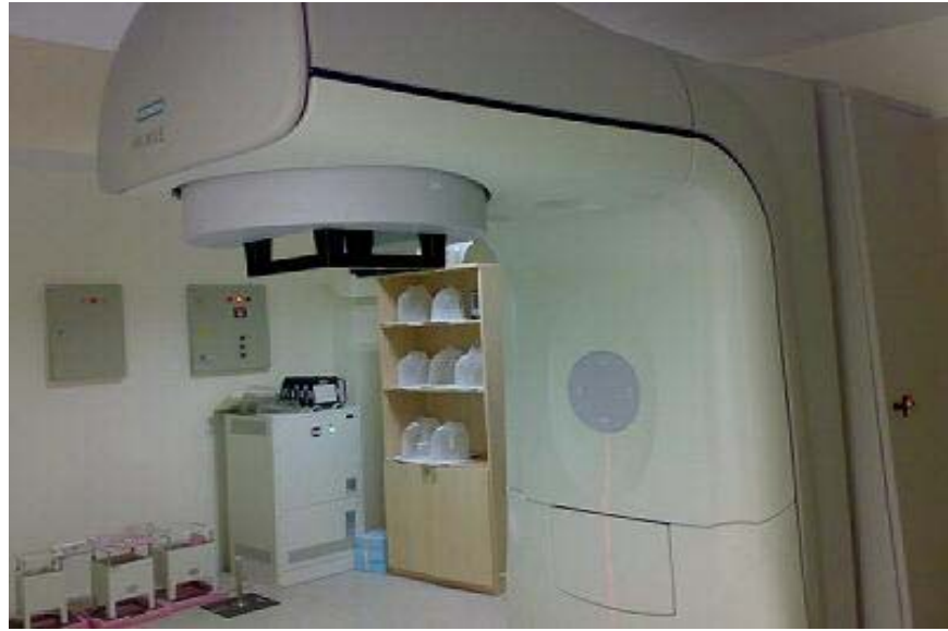
Şekil 3.1 Siemens Primus Mid Energy M5006 lineer hızlandırıcı cihazı
