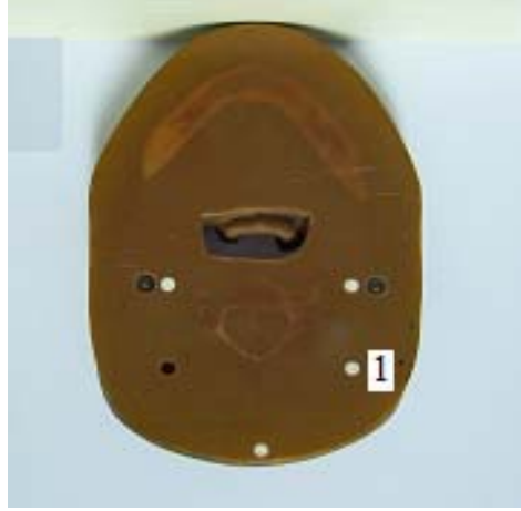
Şekil 4.30 Baş-boyun ışınlamasında tedavi alanına giren kesitteki TLD yerleri (Rando fantomda 8 nolu kesit)
