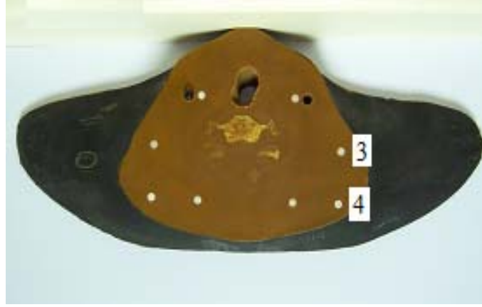
Şekil 4.32 Baş-boyun ışınlanmasında tedavi alanına giren kesitteki TLD yerleri (Rando fantomda 10 nolu kesit)
