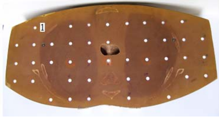
Şekil 4.23 Meme ışınlamasında tedavi alanına giren kesitteki TLD yerleri (Rando fantomda 14 nolu kesit)
