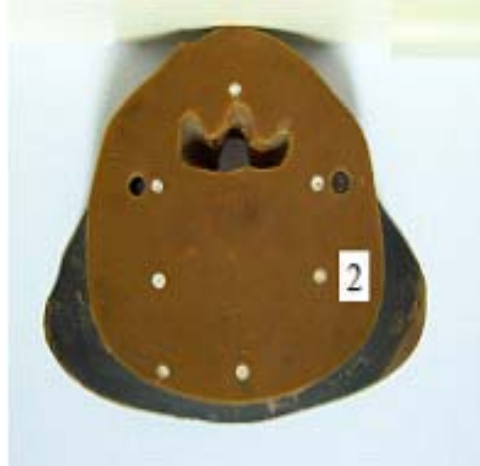
Şekil 4.31 Baş-boyun ışınlamasında tedavi alanına giren kesitteki TLD yerleri (Rando fantomda 9 nolu kesit)
