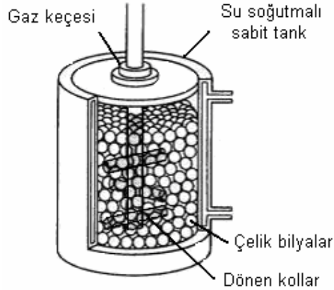
Şekil 4.4. Atritör öğütme haznesi ayrıntısı
