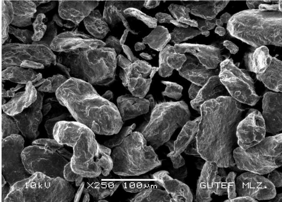
Resim 6.1. Magnezyuma (Mg) ait SEM fotoğrafı (x250)
