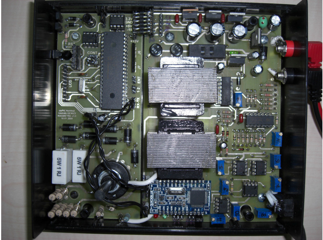
Resim 7.1. Tasarlanan mAs-metre'nin montajlanmış hâli
