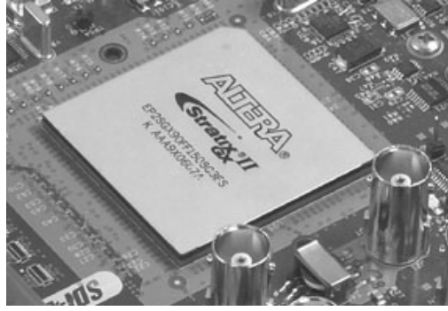
Şekil 6.1.1 FPGA - Alanda Programlanabilir Kapı Dizisi
