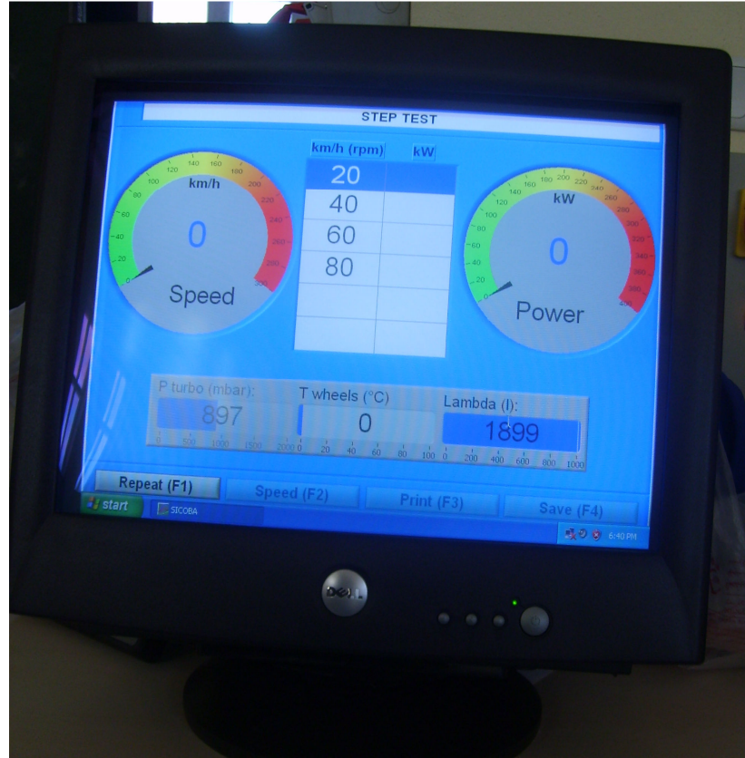
Şekil 3.3. Taşıt dinamometresi kontrol paneli
