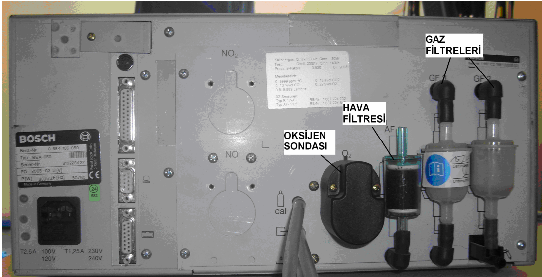
Şekil 3.5. BOSCH BEA-050 marka egzoz emisyon cihazı
