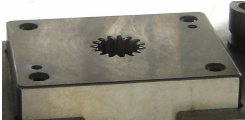
Şekil 5.6. Metal Tozlarının Dolumu Yapılan Kalıbın Dişi Plakası Görüntüsü
