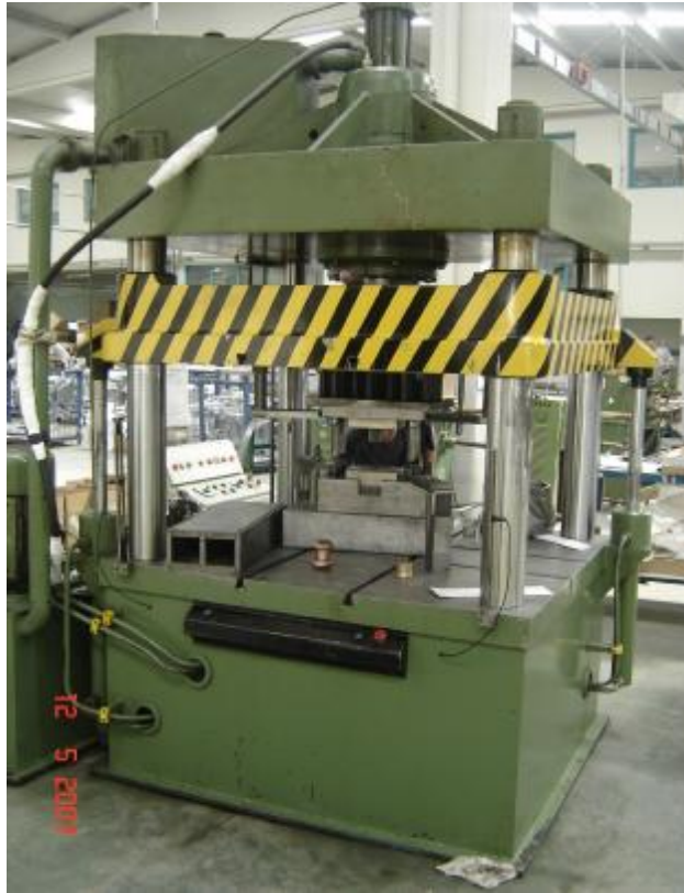
Şekil 5.8. Düz Dişli Sıkıştırma Kalıbı Ve Sıkıştırma İşleminin Yapıldığı Hidrolik Pres
