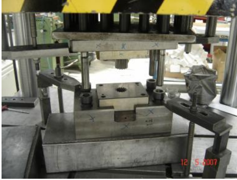
Şekil 5.7. Kalıbın Hidrolik Pres Üzerine Montaj Görüntüsü
