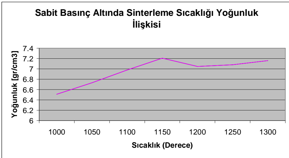
Şekil 5.18. Sabit Basıncıta Sıkıştırılmış (754 MPa) Dişlilerin Sıcaklık Yoğunluk İlişkisi
