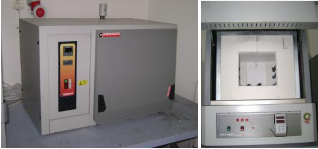
Şekil 5.15. Sinterleme İşleminin Yapıldığı Fırınlara Ait Görüntüler.
