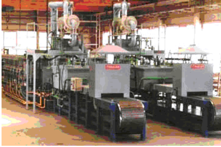
Şekil 2.21. Hareketli Bant Sistemine Sahip Bir Sinterleme Fırını (Kurt, 2002)
