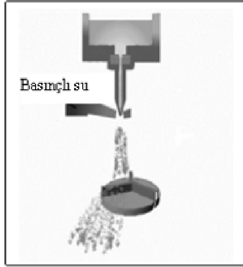
Şekil 2.6. Döner Disk Atomizasyon Yöntemi (Baksan ve diğerleri, 2003.)
