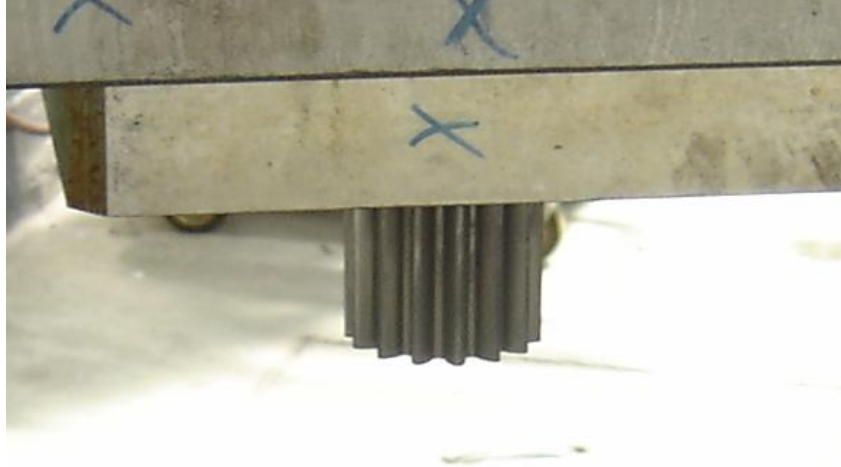
Şekil 5.5. Sıkıştırmayı Yapan Kalıbın Erkek Zımba Görüntüsü
