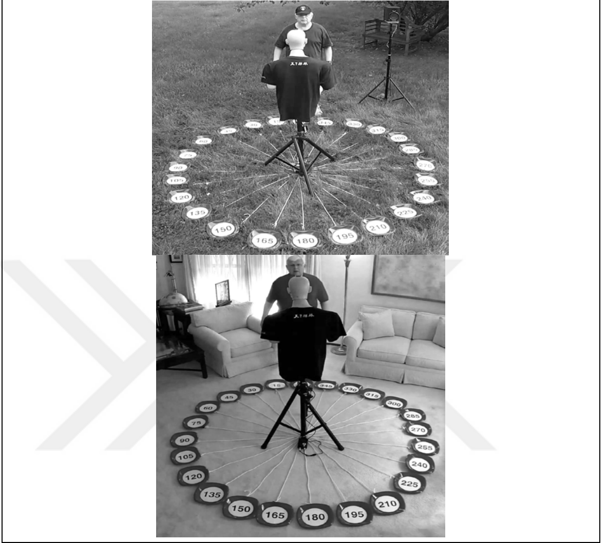
Şekil 2.33: Dış Ve İç Mekanda Yapılan Testlerin Ölçüm Açıları
