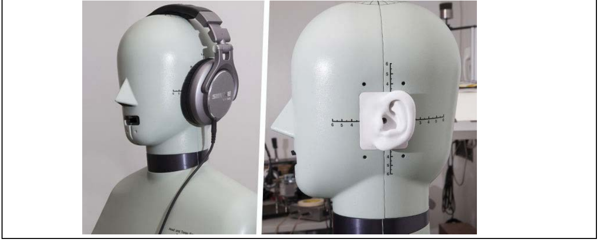
Şekil 2.32: HEAD Akustiğin Yapay Kafa Ölçüm Teknolojisi Gösterimi
