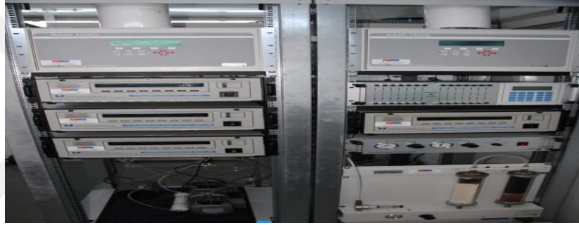
Şekil 3.3: Partikül madde ve gaz ölçüm cihazları.
