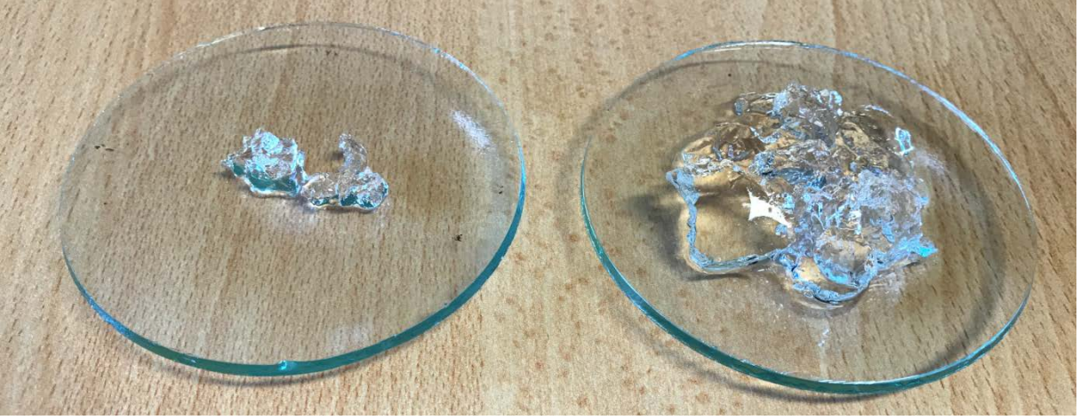
Şekil 4.45: n_{AAm}=0.075 mol, n_{MBAA}=7,5 \times 10^{-4} , n_{SVS}=0 ve n_{AAm}=0.06 mol, n_{MBAA}=7,5 \times 10^{-4} ve n_{SVS}=0.015 mol içeren hidrojellerin şişmiş hallerinin karşılaştırılması.
