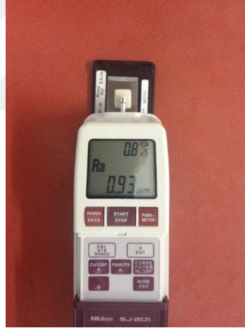
Resim 11: Test örneklerinin yüzey pürüzlülük ölçümlerinde kullanılan profilometre cihazı
