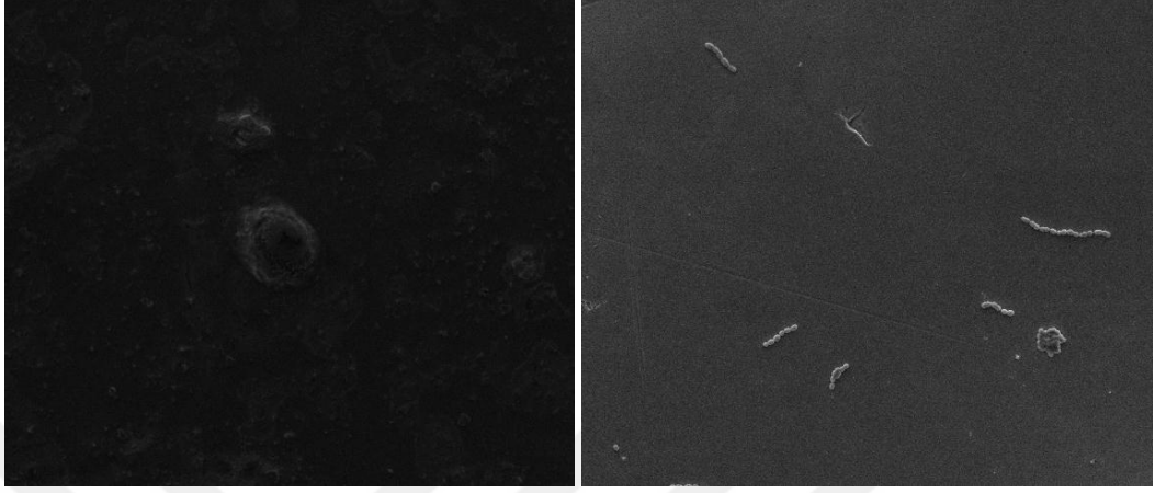
Resim 30: Yaşlandırma öncesi ve sonrası IPS inLine toz-likit glazür sistemi SEM görüntüleri
