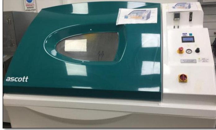
Şekil 23. ISO 9227 Tuz Püskürtme Testinde kullanılan tuz püskürtme kabini
