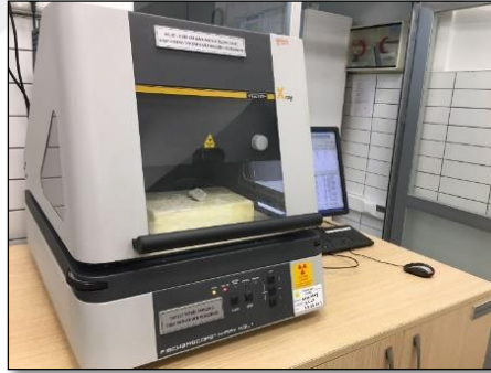
Şekil 20. X-ray kaplama kalınlığı ölçüm cihazı
