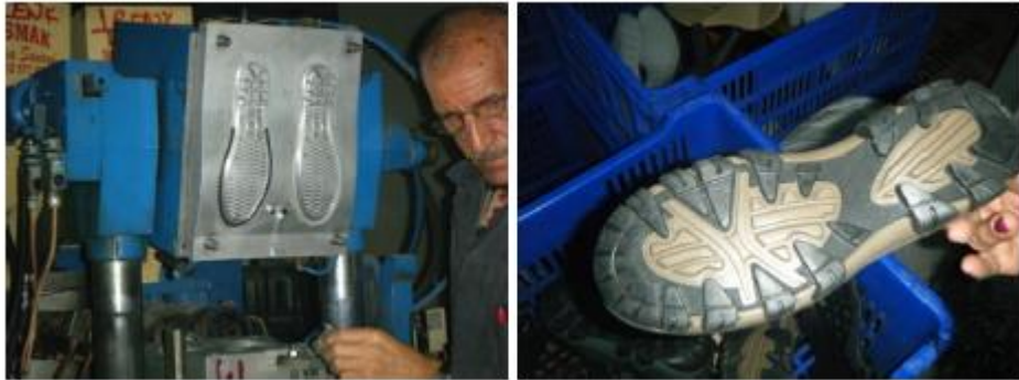
Şekil 17. A-B.Tabanın Kalıplama Yöntemiyle Basılması (Pames Grup)
